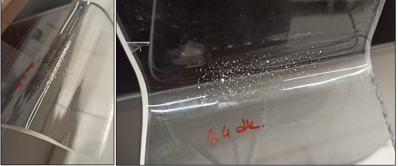
Resim.4-5 : Levha tek taraflı ısıtma örnek uygulama
