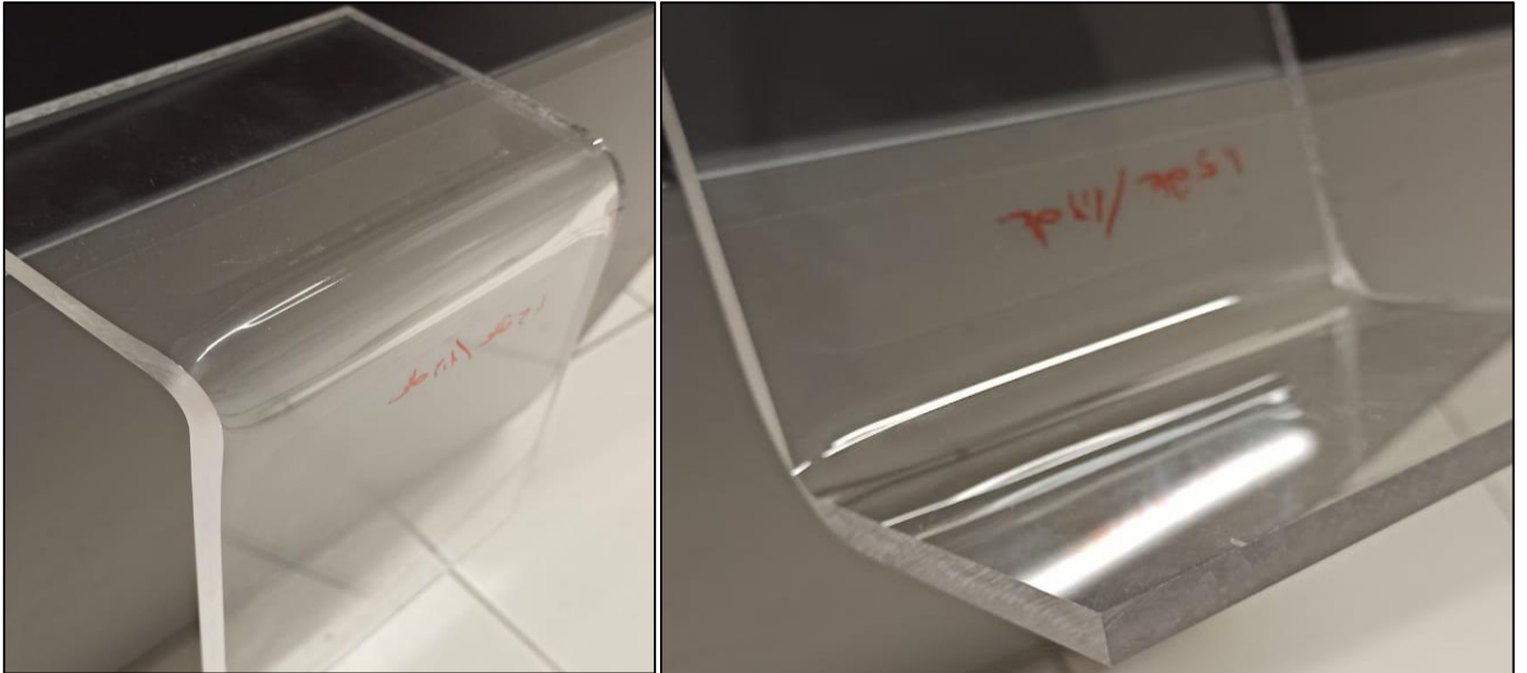
Resim.3-4 : Levha iki yüzey ısıtması örnek uygulama
