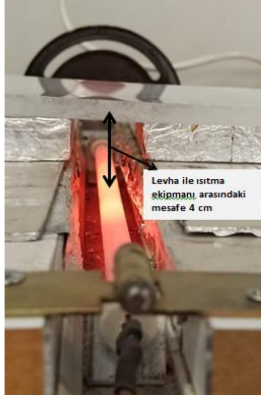
Resim.2 : Levha ısıtma mesafesi
